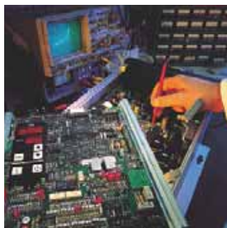
Réparation d'une carte électronique.
